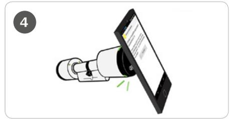
**TIPP für NFC:** Die Schließkomponente sollte an der Stelle der NFC-Antenne beim Smartphone angehalten werden.
