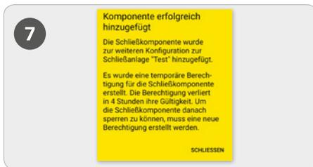
› Via NFC halten Sie erneut das Smartphone an die Schließkomponente im Auslieferungszustand um den Vorgang abzuschließen. Verlassen Sie mit dem Smartphone keinesfalls die Reichweite der NFC- Verbindung zur Schließkomponente.
